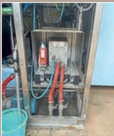
Σε αυτόν τον αντιδραστήρα ο πολτός αναβαθμίζεται με άζωτο χρησιμοποιώντας ηλεκτρική ενέργεια και φυσικό αέρα.
