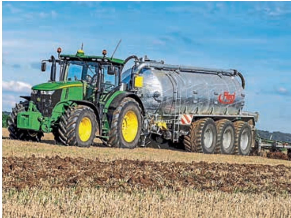
John Deere και βυτιοφόρο Fliegl επιδεικνύουν πώς το σύστημα μπορεί να χρησιμοποιηθεί για τη μεταβολή της ταχύτητας του τρακτέρ ώστε να μεταβάλλεται ο ρυθμός εφαρμογής.
