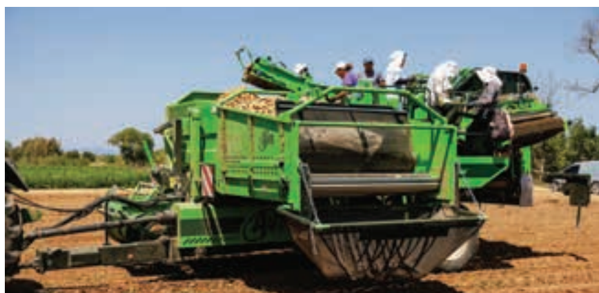
Μια περιστροφική χτένα 3 σειρών απομακρύνει τις πέτρες από τη ροή, ενώ το επίπεδο τραπέζι διαλογής χρησιμεύει ως εργονομική επιφάνεια για τη διενέργεια οπτικού ελέγχου.
