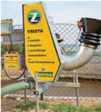
Ο σταθμός NIRS της Zunhammer μετρά τα θρεπτικών συστατικά στο γέμισμα.
